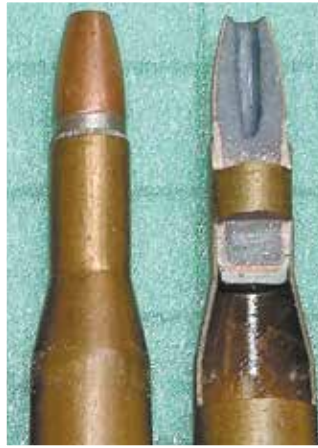
Eine wegweisende Konstruktion: Das Doppel-Mantel-Geschoß von DWM, entwickelt von Walter Lampel Anfang der dreißiger Jahre: Nickelplattiertes Flusseisen außen; Kupfer innen; Bleifüllung und tiefe Hohlspitze; man nannte es damals „Sicherheitsgeschoß“, weil es keinen Ausschuss erzeugen sollte. Es wurde in den Kalibern 5,6; 6,5; 7; und 8mm erzeugt und laboriert. Die abgebildete Patrone ist die .22 Savage (5,6x52R) von 1912 von Konstrukteur Charles Newton für Artur Savage.
